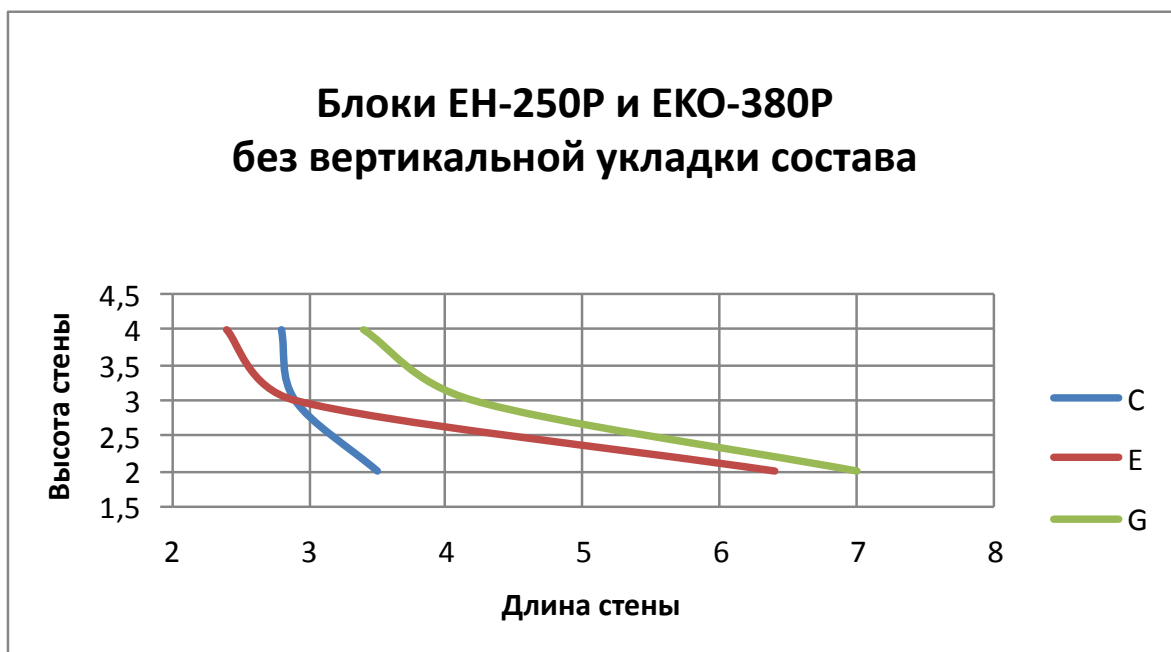
Рисунок 16. Максимальное расстояние опоры стены из блоков Lakka EH-250P и EKO-380P для расчетного показателя ветровой нагрузки 0,675 кН/м 2 .
