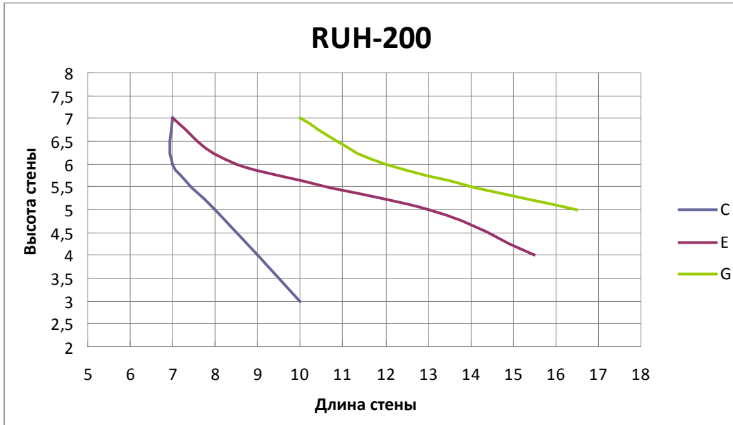
Рисунок 3. Максимальное расстояние опоры стены из блоков Lakka RUH-200 для расчетного показателя ветровой нагрузки 0,675 \text{ кН/м}^2 .
