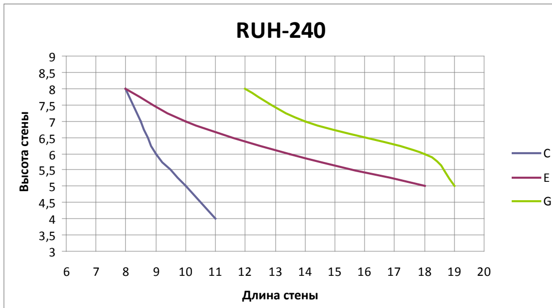
Рисунок 4. Максимальное расстояние опоры стены из блоков Lakka RUH-240 для расчетного показателя ветровой нагрузки 0,675 \text{ кН/м}^2 .
